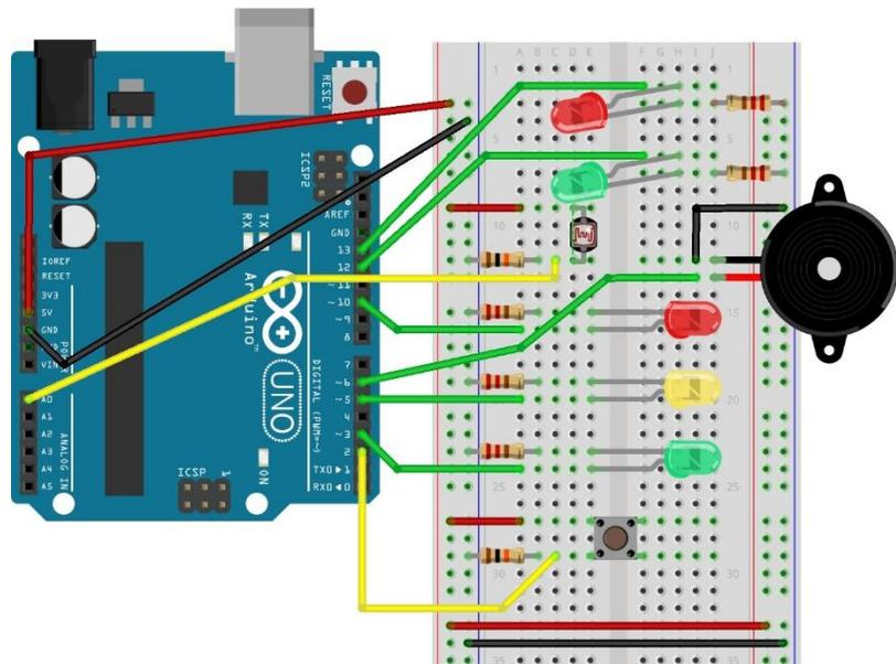
Den anderen Kontakt verbinde direkt mit „Erde“ („**GND**“) – und schon kannst du dem Lautsprecher mit dem von der LED-Programmierung bekannten Befehl `digitalWrite` ein „Knacken“ oder „Ticken“ entlocken – lies' dazu bitte auch die **Erklärungen in der Informationsdatei ST\_I\_09Arduino\_Praxis\_Schall** nach.
