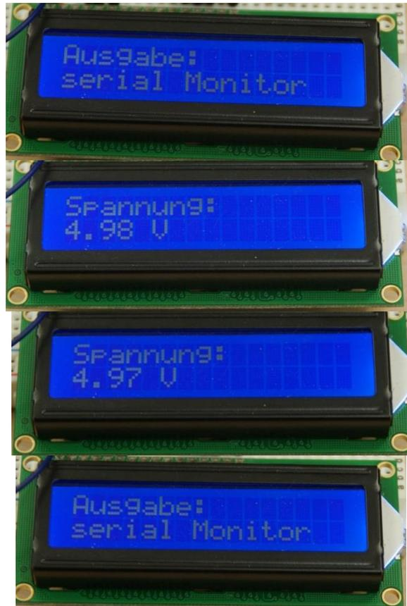
**Aufgabe 7)** Mit dem Code aus **Aufgabe 6)** funktioniert dein Arduino-Voltmeter zwar ohne Computerbildschirm, die elektrische Energie kommt aber nach wie vor vom USB-Port des Computers. Du kannst das Arduino-Voltmeter aber auch völlig unabhängig von einem Computer nutzen, nachdem du das Programm übertragen hast:
