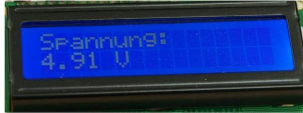
Hinweis: Um – wie in nebenstehender Abbildung 4.91 V – den in einer `float`-Variablen namens `voltage` gespeicherten Messwert (also eine Zahl) UND einen Text ("V") nebeneinander in einer Zeile des LCD anzeigen zu lassen, gibt es zwei Möglichkeiten:
