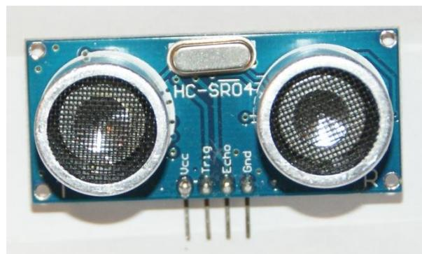
Die Spannungsversorgung des Sensors erfolgt über die beiden äußeren Steckkontakte: Der mit `vcc` beschriftete Kontakt ist mit dem Pluspol (**5 V**), der mit `Gnd` beschriftete Kontakt mit dem Minuspol (**GND**) zu verbinden. Die beiden mittleren, mit `Trig` bzw. `Echo` beschrifteten Kontakte sind jeweils mit einem der digitalen Kontakte am Arduino-Board zu verbinden – die Nummern dieser beiden Kontakte
