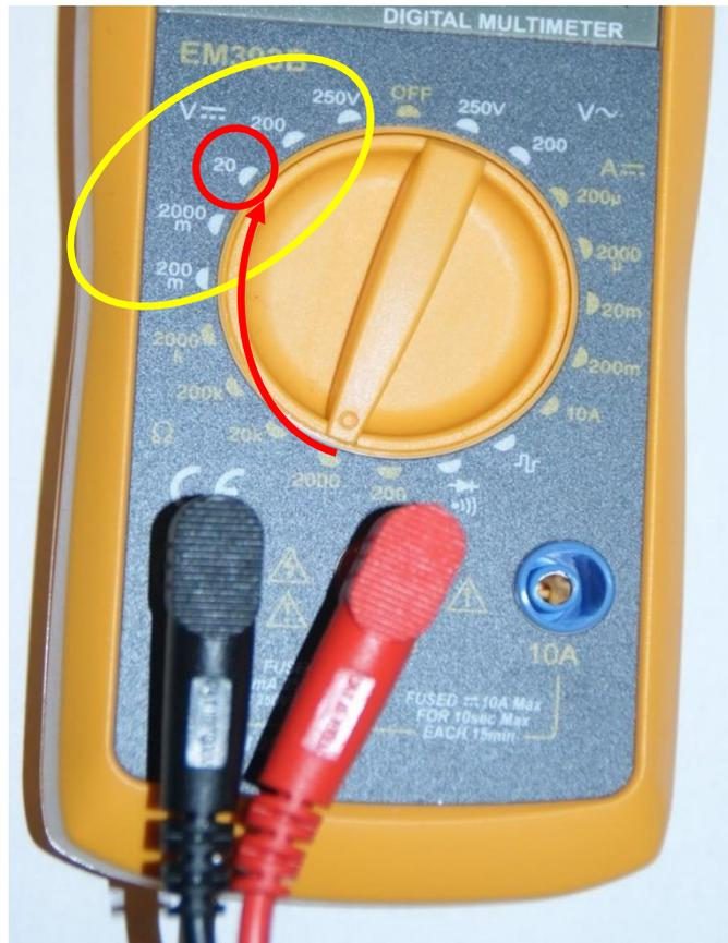
Wenn du beispielsweise bei unserer Ampelschaltung die Messspitze des roten Kabels (vorsichtig) in den durch den roten Punkt markierten Steckkontakt und jene des schwarzen Kabels (vorsichtig) in den durch den schwarzen Punkt markierten Steckkontakt steckst, kannst du die elektrische Spannung (= den elektrischen Druck-unterschied), die (der) den elektrischen Strom durch den gekennzeichneten Widerstand „antreibt“, ablesen:
