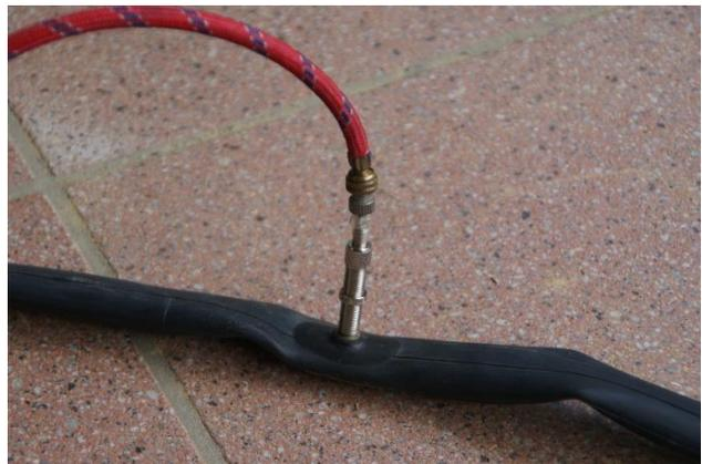
Nach dem Aufpumpen ist der Fahrradschlauch prall gefüllt. Dies kommt daher, dass **im Inneren** des Reifens **ein höherer Druck als außen** herrscht. In der nachstehenden Abbildung ist dies durch unterschiedlich dicke Pfeile angedeutet, die den unterschiedlich großen Druck darstellen:
